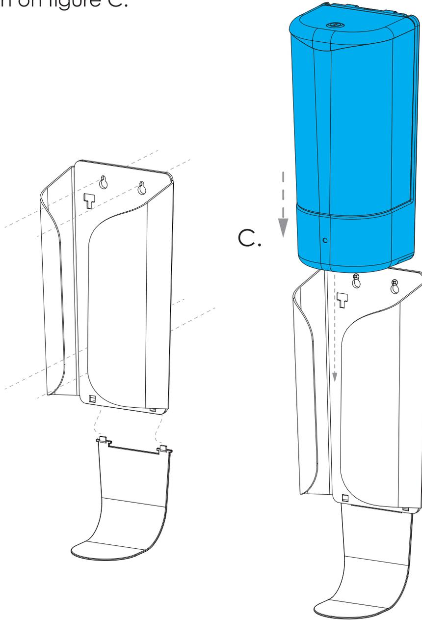
3. Coloque la bandeja de goteo antes de montar la cubierta en la pared. Hay 5 guías deslizantes en la parte posterior de la cubierta. Después del montaje, deslice el dispensador en las guías deslizantes y empuje hacia abajo para bloquearlo. Se muestra en la figura C.
