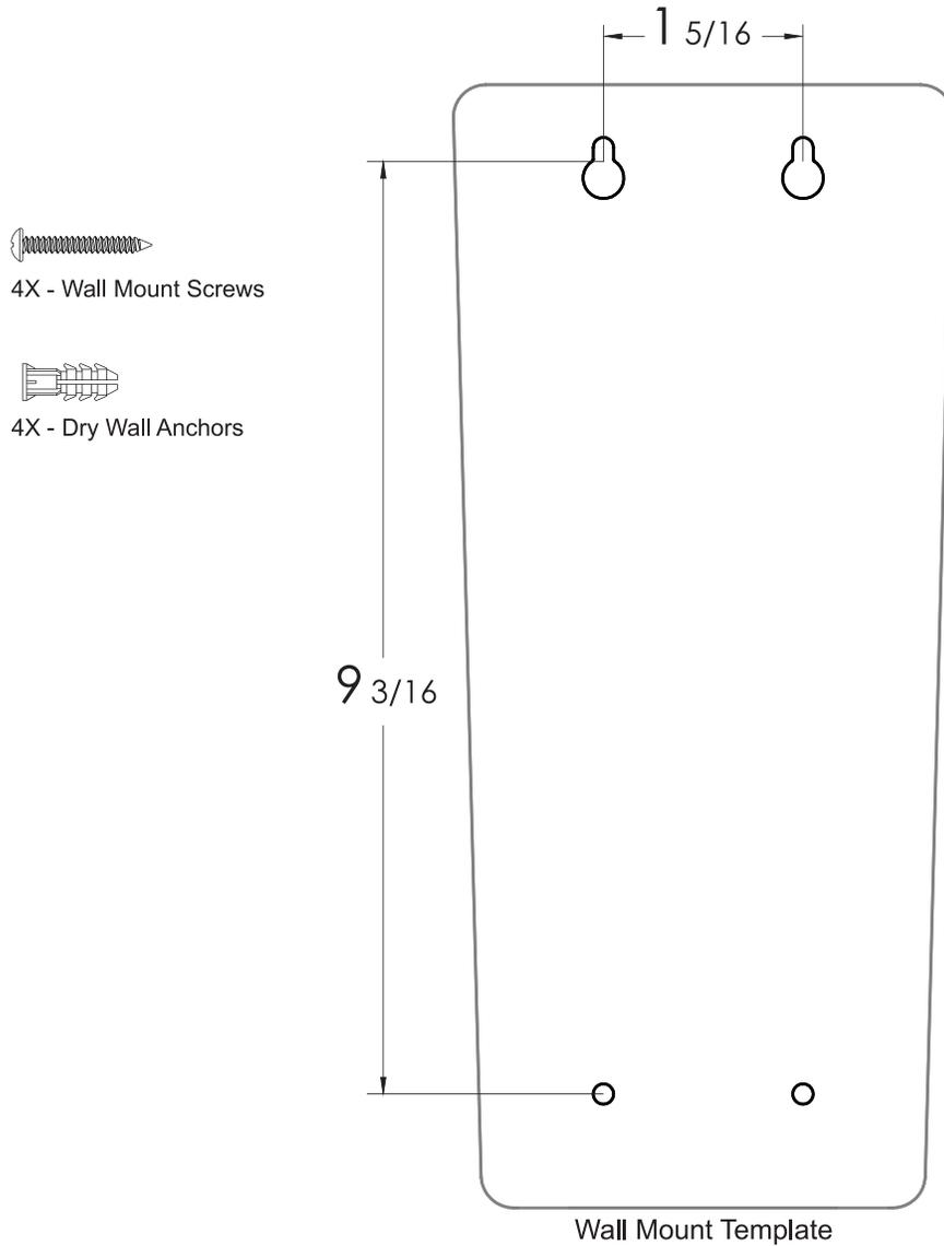
2. El dispensador se puede montar en un soporte o en una pared. Para montar el dispensador en la pared, use la plantilla de montaje en pared. Se incluyen tornillos y anclajes.
