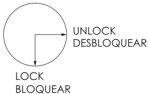
6. Para abrir la tapa del tanque, use la llave provista. Inserte la llave y gírela en sentido antihorario para desbloquear. Abra la tapa y llénela con el gel o líquido desinfectante de manos deseado (1750ml MAX). Cierre la tapa y gire la llave en sentido horario para bloquear.
