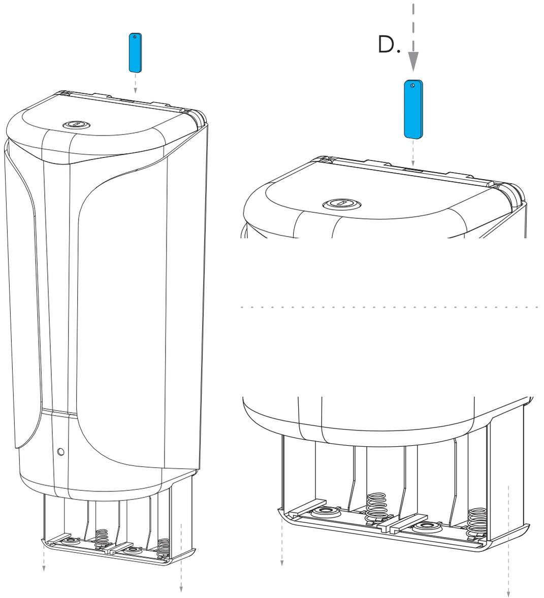
4. Para acceder al paquete de baterías, tome la llave rectangular provista y presione hacia abajo el pestillo de liberación en la parte posterior del dispensador como se muestra en la figura D. El paquete de baterías se deslizará hacia abajo desde la parte inferior del dispensador. Instale 4 baterías C (NO INCLUIDAS) y deslice el paquete de baterías nuevamente a su posición.
